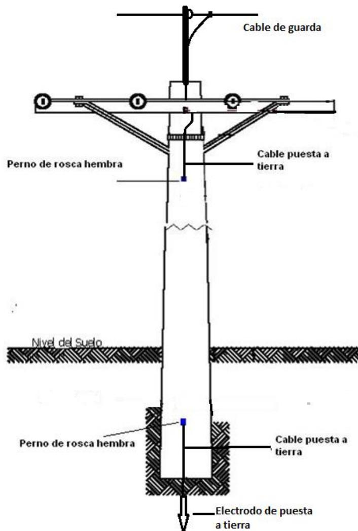
El perno rosca hembra debe permitir conectar y/o sujetar cables acero recubierto de cobre, o acero galvanizado de 3/8". En caso de no existir cable de guarda, la conexión de puesta a tierra se efectuará solamente en la parte inferior del poste.
