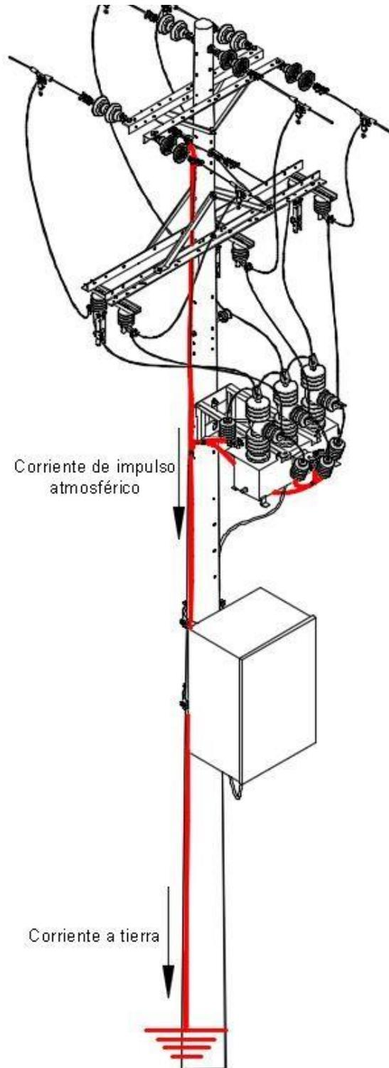
En el caso de una estructura con redes de media y baja tensión, como se muestra en la Figura 2, el sistema de puesta a tierra considerado debe soportar y disipar tanto la corriente a tierra producida por una eventual falla en el lado de baja del transformador como las posibles corrientes por descargas atmosféricas que circulen por los DPS.
